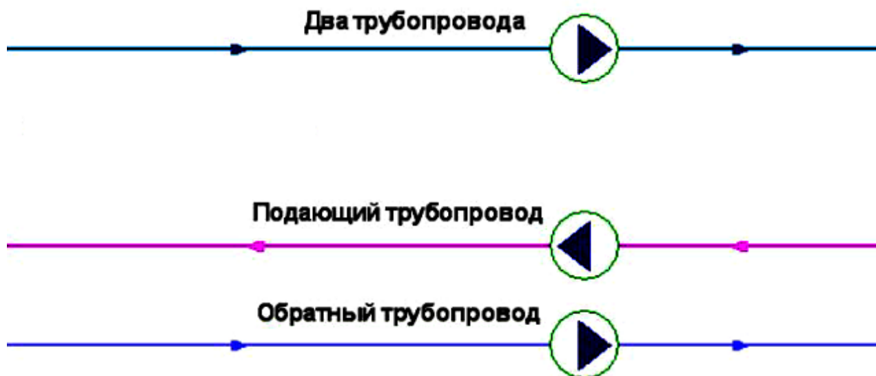
Рис. 13 Сверху: однолинейное изображение, снизу – внутреннее представление
